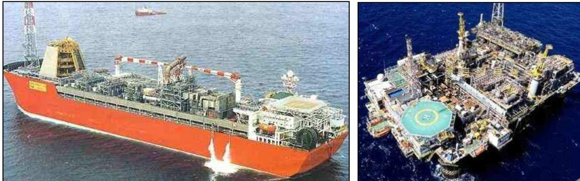
Figuras 3 e 4 – FPSO e Plataforma semi-submersível
